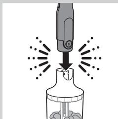
**4** Прикрепите блок электродвигателя к приводу измельчителя XL (должен прозвучать щелчок).
