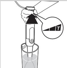
**5** Включите прибор нажатием на переключатель. Вы можете увеличить скорость работы прибора сильным нажатием на переключатель. Нажатие на переключатель до упора переведет блендер в турборежим.
