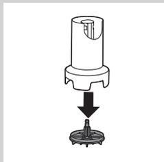
**13** Снимите вращающуюся пластину с привода.
