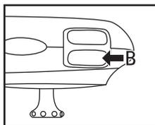
Способ 3: установите дрон на ровную горизонтальную поверхность и нажмите кнопку «В». Квадрокоптер взлетит в автоматическом режиме и зависнет на заданной высоте.
