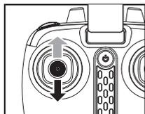
3. Переместите левую ручку пульта управления до упора вверх, а затем до упора вниз. Когда прозвучит длинный звуковой сигнал, это значит, что связь пульта с квадрокоптером установлена и определение носовой части в режиме «Headless» завершено.
