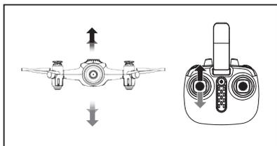
При перемещении левой ручки пульта (Газ/Курс) вверх дрон набирает высоту. При перемещении этой ручки вниз дрон снижается.
