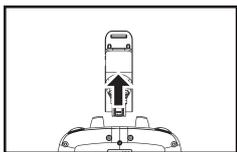
Чтобы снять кронштейн с пульта управления, снимите с кронштейна смартфон, а затем с усилием потяните кронштейн для смартфона вверх.
