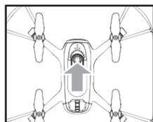
Шаг 2: включите питание дрона, нажав и удерживая 1-2 секунды кнопку включения/выключения питания, расположенную сверху корпуса дрона.
