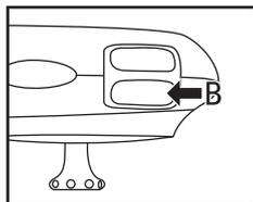
Способ 3: когда дрон находится в полете, нажмите на пульте кнопку «В», квадрокоптер медленно приземлится и моторы автоматически выключатся.
