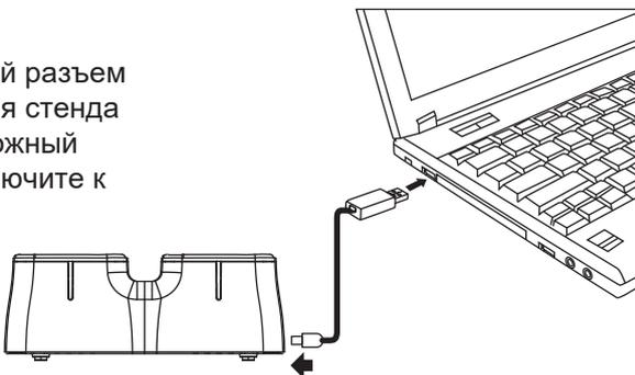
2. После подключения стенда для зарядки к компьютеру будет светиться индикатор. Вставьте аккумулятор в стенд для зарядки. В процессе зарядки индикатор будет светиться, а когда индикатор погаснет, это значит, что процесс зарядки завершен и аккумулятор полностью заряжен.
