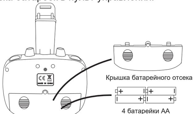
Установка батареек: откройте крышку батарейного отсека на задней панели пульта. Строго соблюдая полярность, в соответствии с метками полярности в батарейном отсеке, установите 4 батарейки АА (не входят в комплект) и закройте крышку батарейного отсека пульта управления.
