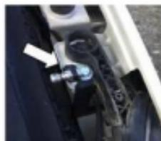
2. Установить кронштейн крыла с болтом М6х20, как показано на рисунке. Затянуть болт ключом №10 с усилием 9 Нм.
