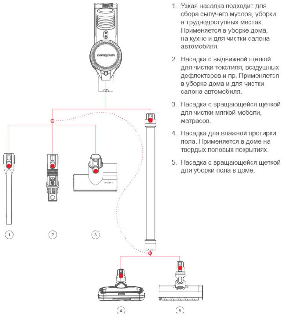
Для установки насадки соедините насадку / трубку с пылесосом, как показано на рисунке. При правильном соединении срабатывает защёлка-фиксатор. Для снятия насадки / трубы нажмите на красную кнопку фиксатора насадки, как показано на рисунке, и потянув снимите насадку.
