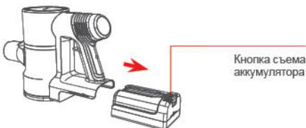
Для отсоединения аккумулятора от пылесоса нажмите на кнопку съема аккумулятора и извлеките аккумулятор, как показано на рисунке. Для подключения аккумулятора к пылесосу просто вставьте его обратно.
