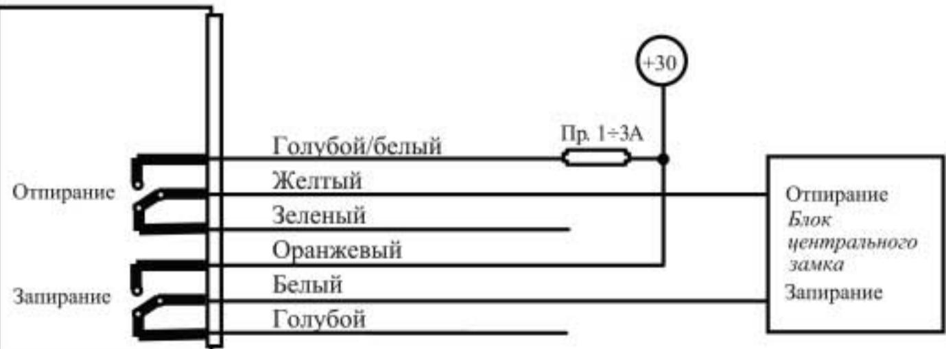
**Подключение дополнительного канала 2 для реализации функции «Закрытие стекол при постановке на охрану»**
