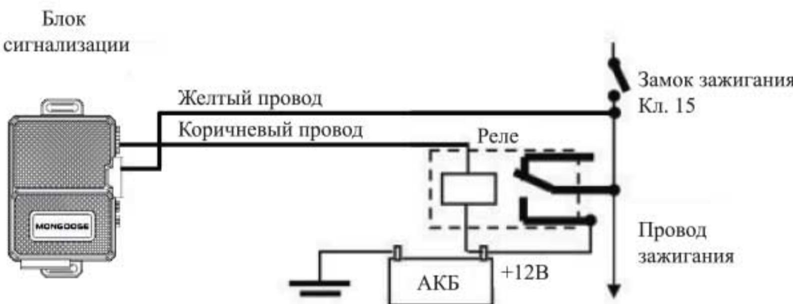
**Подключение нормально разомкнутого реле блокировки**
